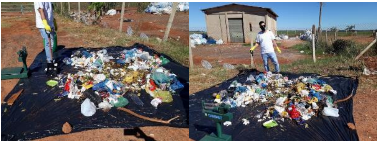
Figura 29: Separação em quatro partes após a homogeneização
