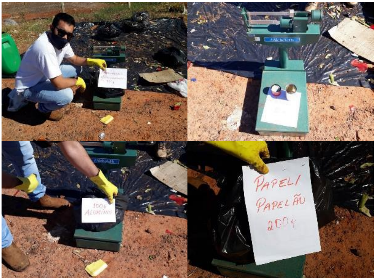
Figura 31: Pesagem dos resíduos por classificação do tipo de material.
