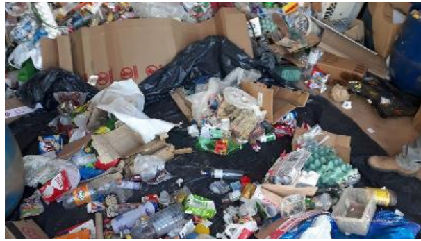
Figura 39: Separação em quatro partes após a homogeneização
