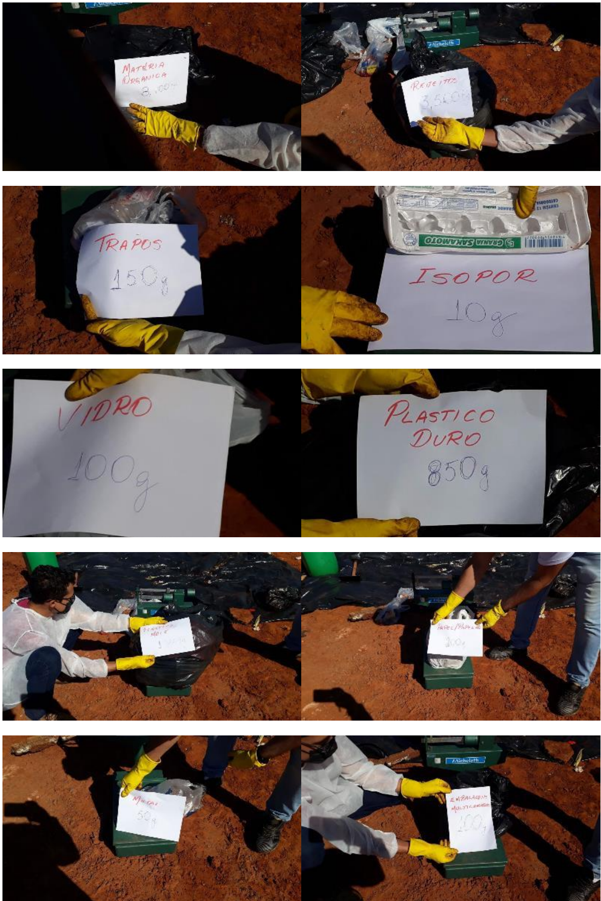
Figura 35: Pesagem dos resíduos por classificação do tipo de material.
