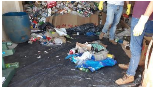
Figura 40: Escolha de duas partes mais heterogêneas para separação por tipo de resíduo
